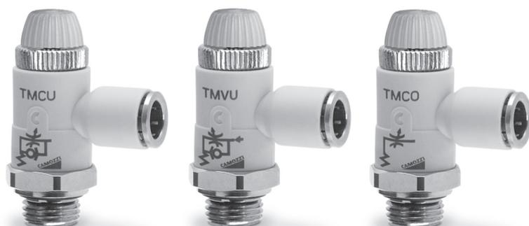
Пневмодроссели с обратным клапаном и без Серий TMCU, TMVU, TMSO обладают малыми размерами и улучшенными расходными характеристиками. Конструкция дросселей обеспечивает простую установку непосредственно на цилиндры и распределители, а также позволяет заблокировать настроечный винт после установки расхода (скорости передвижения).
